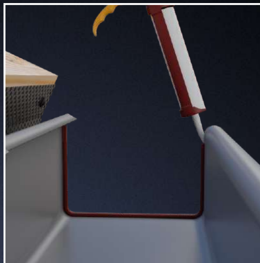
Wykonanie uszczelnienia zakończenia rynny przez zastosowanie odpowiedniego do tego celu spoiwa - nałożenie spoiwa NA RYNNĘ.
