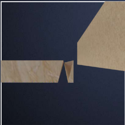
Płytę montowaną poziomo przycinamy piłą pod kątem, tak aby po połączeniu płyt utworzył się spadek. Spadek powinien wynosić 4mm na każde 22cm głębokości parapetu
