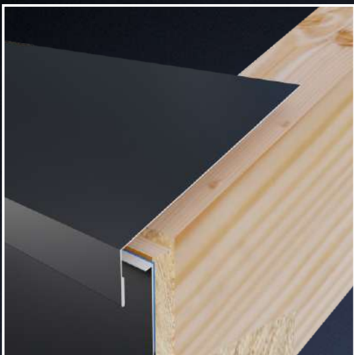
Montaż pasa podrynnowego (skroplinowego).
